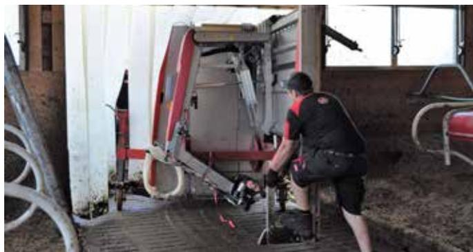
Déménagement du robot de traite de l'emplacement provisoire à l'emplacement définitif.
